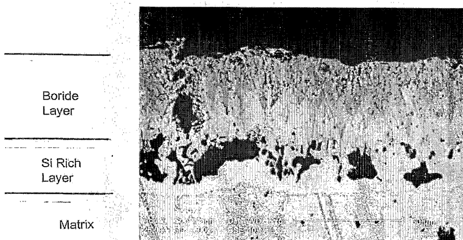
شکل ۴-۱۲- پروفیل تغییرات عنصر سیلیسیم در نمونه ای که در دمای ۸۵۰ درجه سانتیگراد تحت دانسیته جریان ۰/۱ آمپر بر سانتیمتر مربع به مدت ۲ ساعت تحت فرآیند برآیند برای دینگ قرار گرفته است
